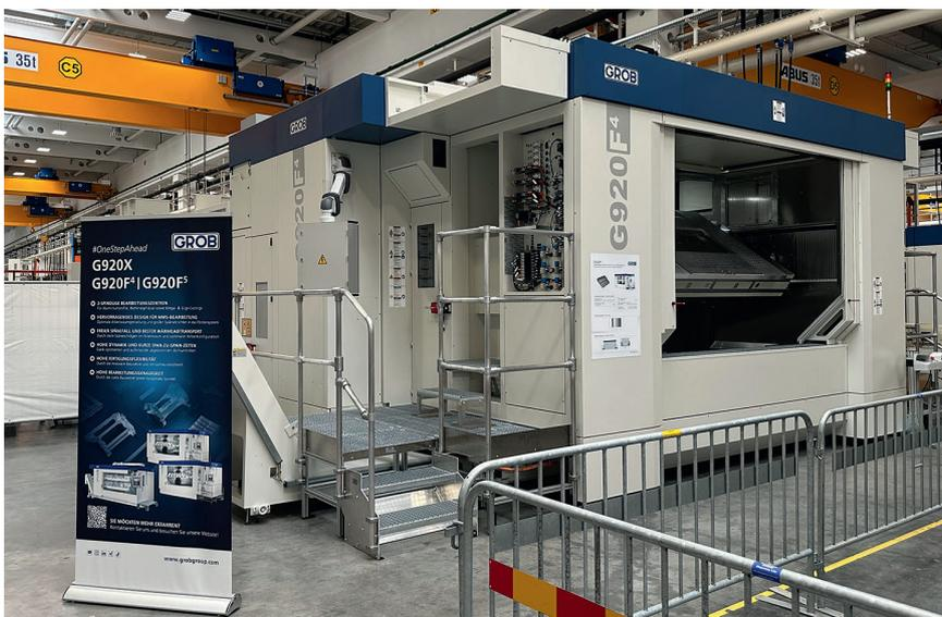
**1** Vorstoß in neue Werkstückdimensionen: die G920F<sup>4</sup> ist ein vierachsiges, zweispindliges Bearbeitungszentrum, mit dem Grob Zulieferer und OEMs in puncto Bearbeitung von Strukturbauteilen wie Aluminiumprofile, von Batteriegehäusen sowie Mega- und Giga-Castings – bevorzugt in der Elektromobilität – adressiert © Hanser
