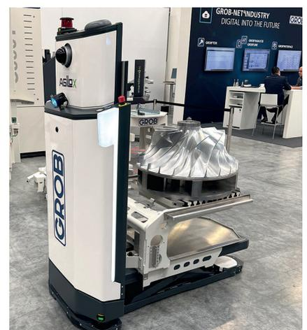
**2** Smartes Produzieren mit automatisierten Maschinen leichter gemacht: fahrerlose Intralogistik von Werkstücken, Werkzeugen, Vorrichtungen, Paletten, Spänekübeln et cetera mit dem neuen Grob Mobile Robot (GMR) © Hanser
